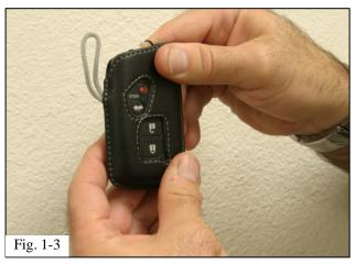
(d) Adjust the fit so the windows align with the buttons on the remote (Fig. 1-3).
